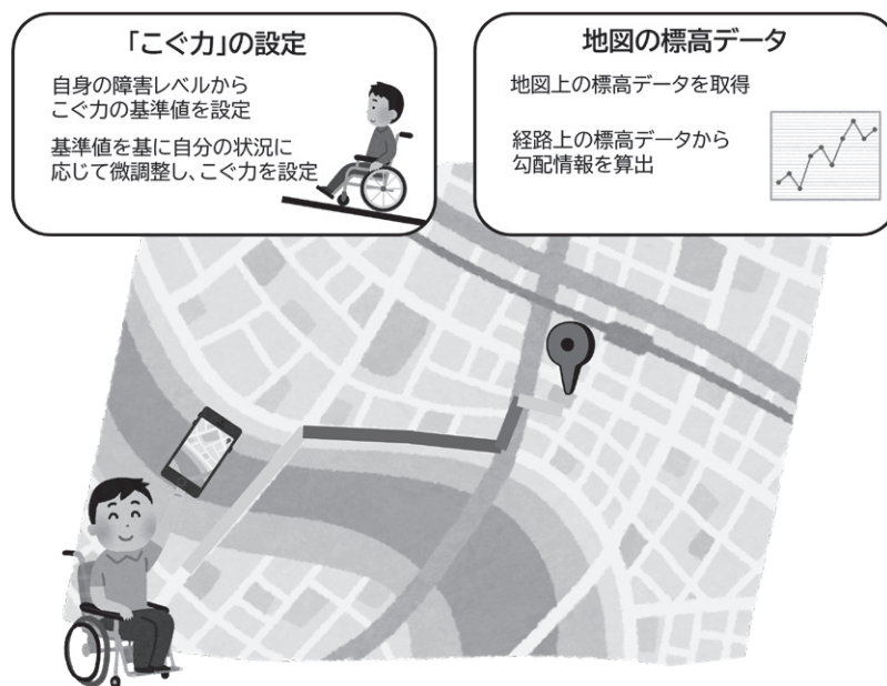
図1 車椅子使用者の安全移動経路提示に関する研究開発のコンセプト
