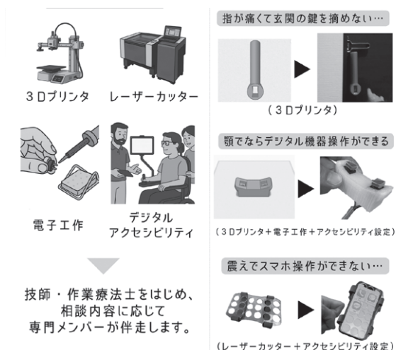
図3 自助具作製への工作機器・技術応用
