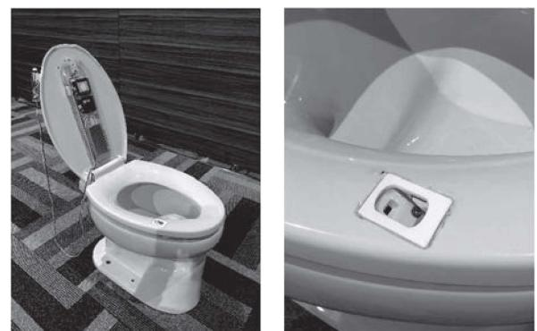
図3 製作したセンサ付測定便座
