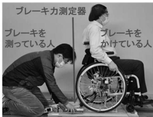
図2 ブレーキ力測定時の様子
