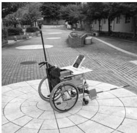
(a) GNSS 受信機を搭載した測位実験
