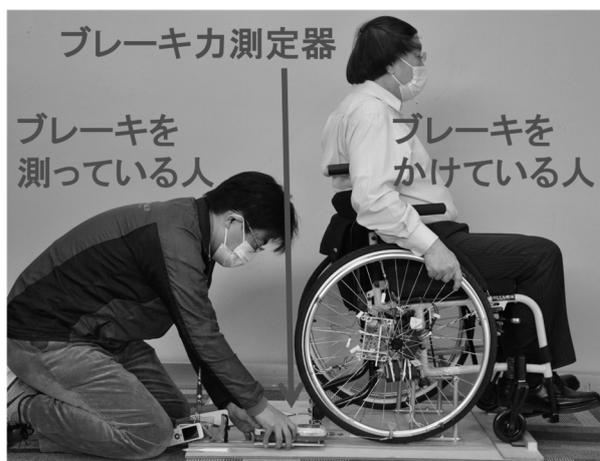
図3 ブレーキ力測定時の様子
