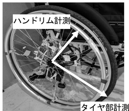
計測箇所の半径が異なるため、計測した力を直接比較できない。力をトルクに換算することで比較できる。
