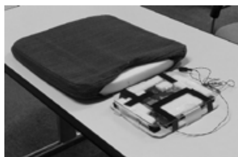
図 6 着座検知センサ（座布団に納めて使用）
