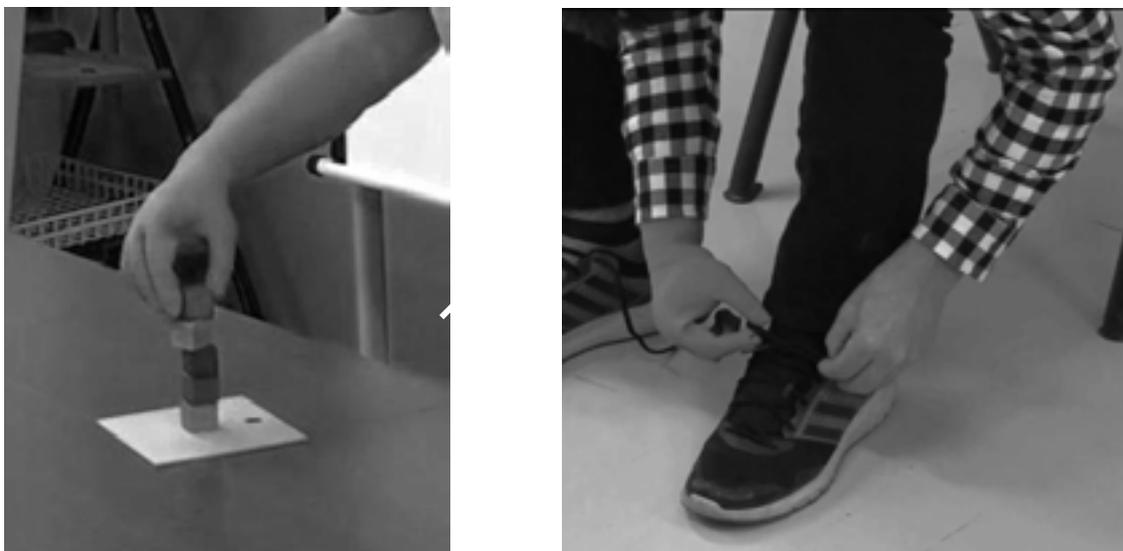
図6 摘み性能を向上させた筋電義手（右手が開発した義手）
