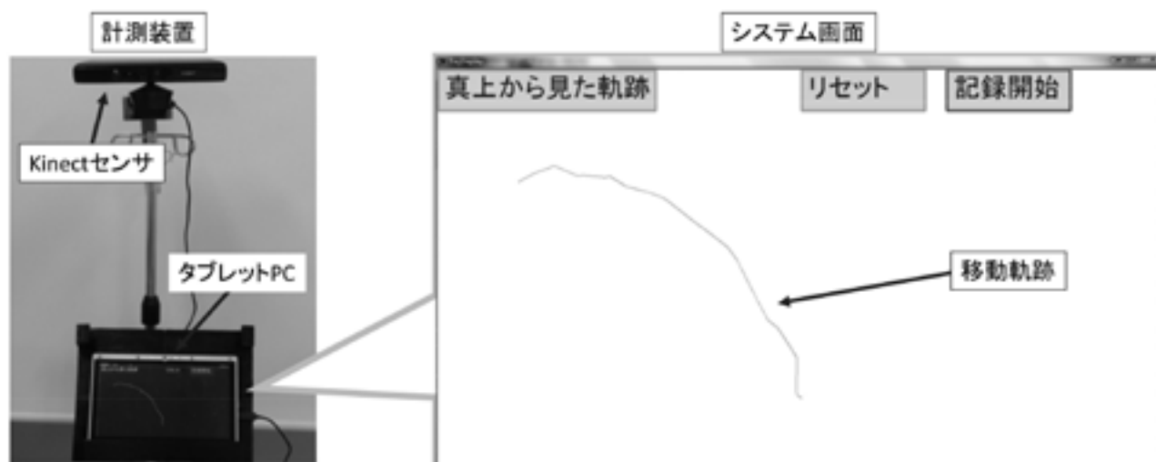
図1 開発したロボットリハビリテーションの計測評価装置の外観
