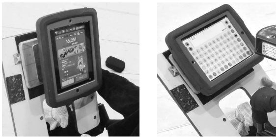
図3 電動車椅子の工夫 Fig.3 Turntable for iPad
