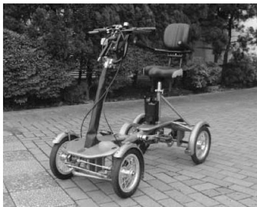
図1 4輪型電動アシストパーソナル・モビリティ
