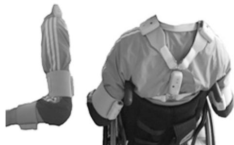
図4 ネオプレンベルトによるセンサの固定
