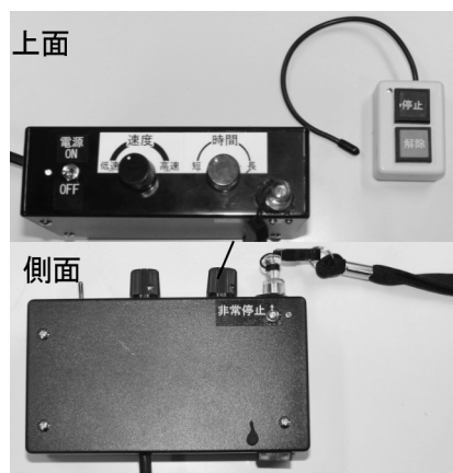
図5 学習支援機能モジュール（緊急停止装置・データ記録・駆動時間制御）
