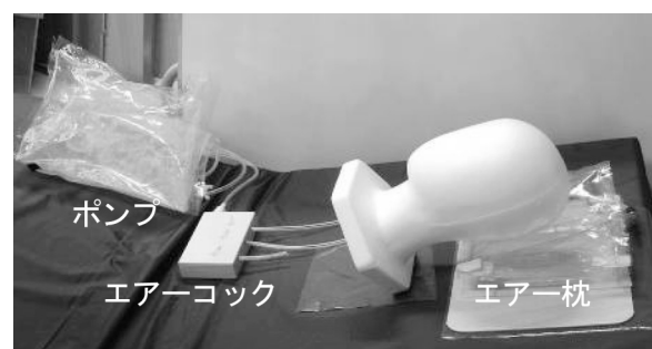
図7 エアー枕構成図 Fig.7 Setup of Air pillow
