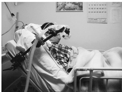
図9 作製したアームの取り付け状況
