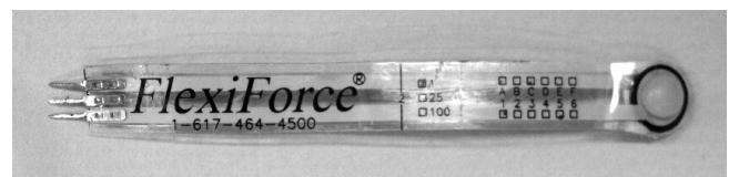
図9 現在使用しているスイッチ(圧力センサ)
