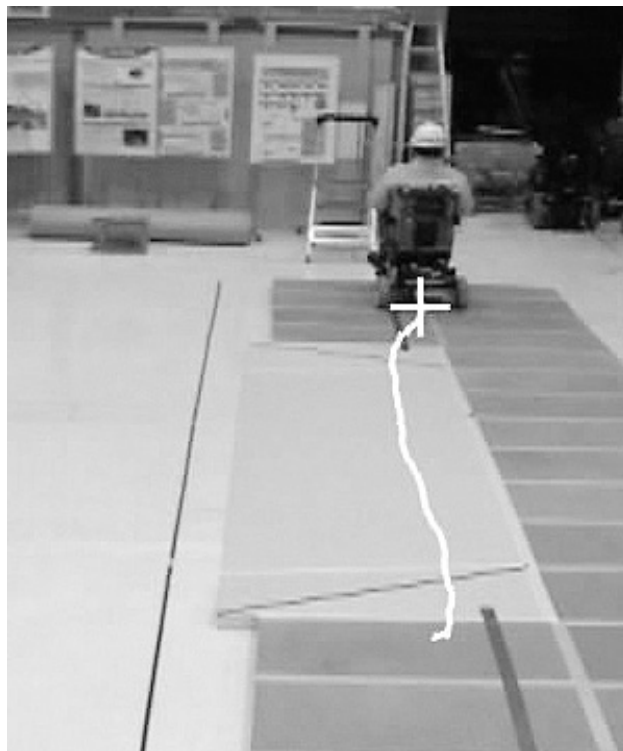
図6 傾斜路面において直進走行スイッチを押した場合の軌跡 Fig.6 Track on a slope with the prototype system
