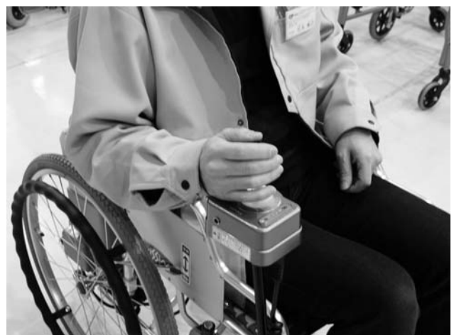
図5 ジョイスティックによる走行テスト
