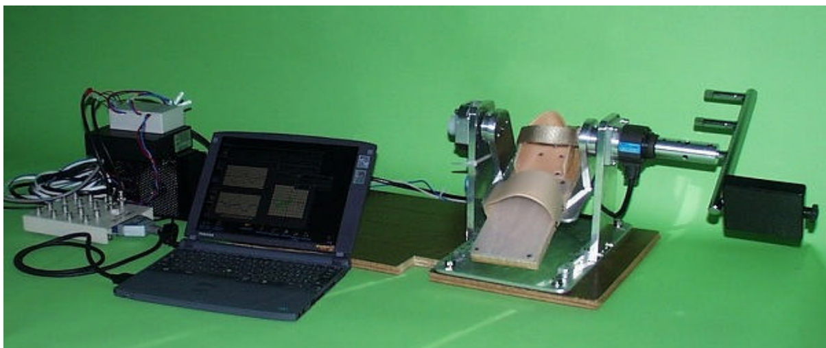
図1 剛性計測装置の全体像（足関節計測モード）と短下肢装具計測部（右上）
