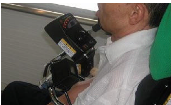
図 8 チンコントロールによるレバー操作 Fig.8 Operation of the joystick using chin
