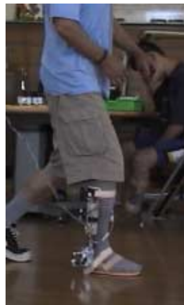
(b) 切替操作が遅れ踵接地時に継手粘性大
