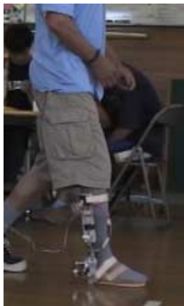
(a) 踵接地時に継手粘性小
