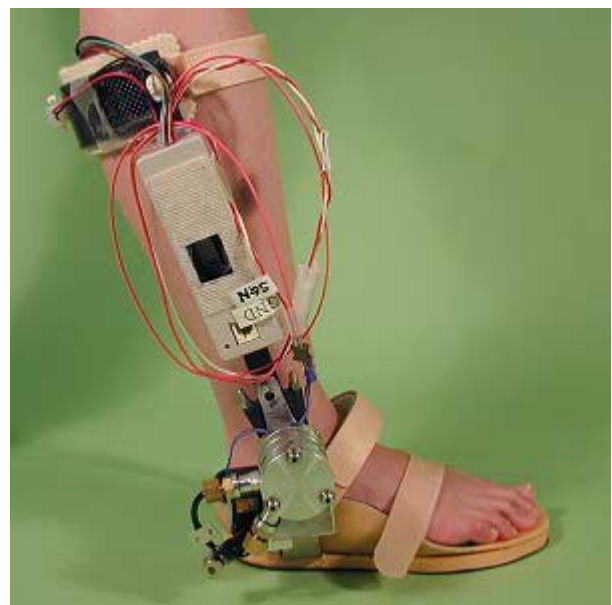
図2 試作した抵抗可変継手付きAFO
