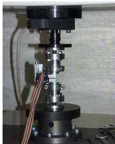
図 4 圧縮に対するキャリブレーション Fig.4 Calibration for compression
