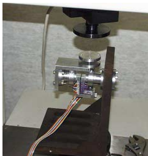
図 5 せん断に対するキャリブレーション Fig.5 Calibration for shear force
