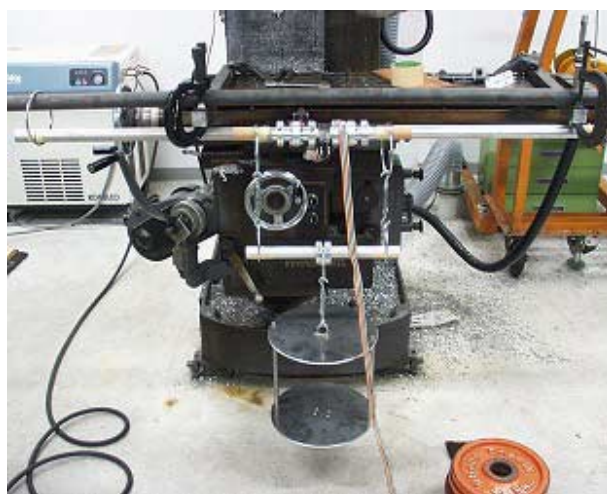
図 6 曲げに対する 4 点曲げキャリブレーション Fig.6 Calibration for 4 point bending
