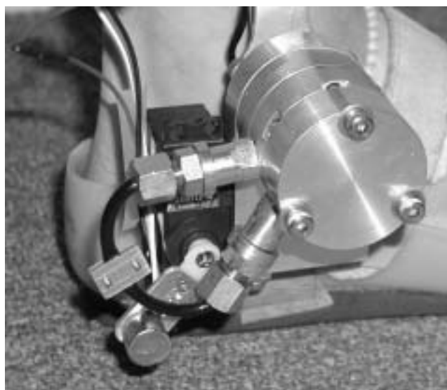
図4 実験用短下肢装具 装着時の様子(左) 継手部(上) (磁石を位置Aよりさらに離している)
