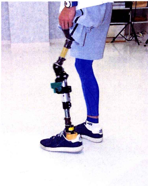
図6 荷重ブレーキのテスト Fig.6 Test to weight-activated brake system
