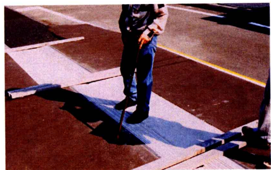
写真12 杖等使用の立位高齢者 官能試験状況 Pic.12 Sensory test by elderly people with safety cane
