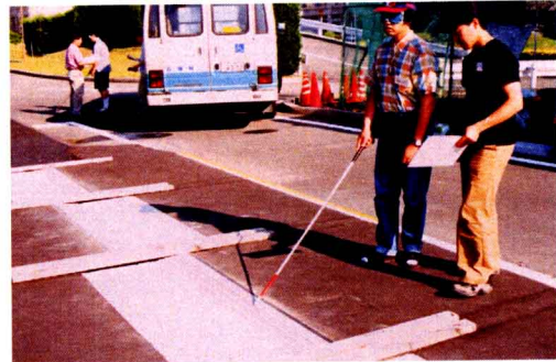
写真11 視覚障害者官能試験状況 Pic.11 Sensory test by visually impaired people
