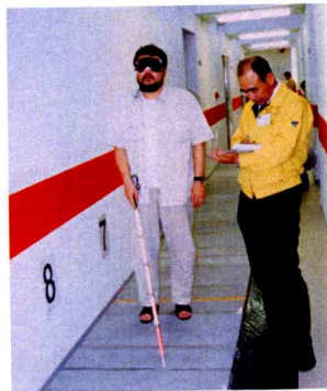
写真5 溝官能試験状況 Pic.5 Sensory test on the groove
