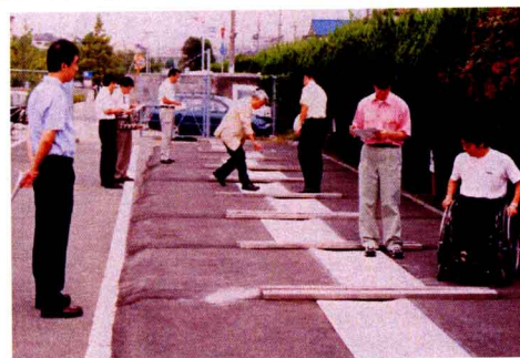
写真13 車いす使用者官能試験状況 Pic.13 Sensory test by wheelchair users
