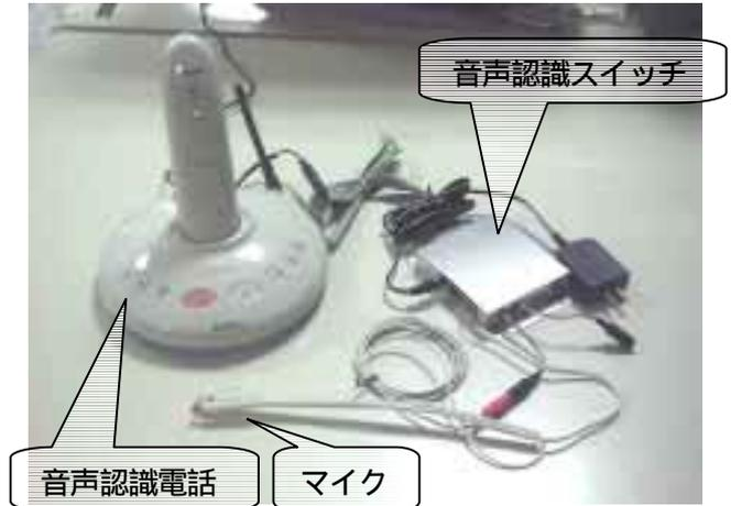
図1 音声認識スイッチと音声認識電話
