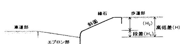
図5 現行の縁石ブロックタイプ別段差 $H_1$ 評価
