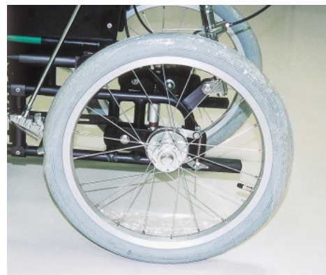
図 4 : 開発した後輪懸架機構
