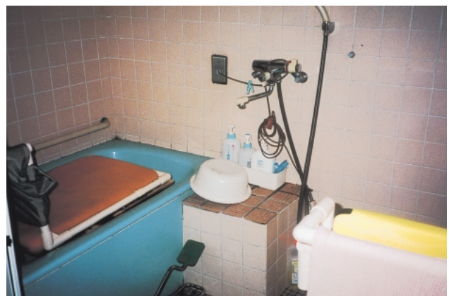
写真2：使い勝手の悪い浴室 (小さな洗い台が中央にあるが物置台としてしか利用されていない。正面の壁の右側にはシャワーチェアが固定されていたが外している。浴槽内の昇降機は専門機関に相談して製作したが問題がある。)
