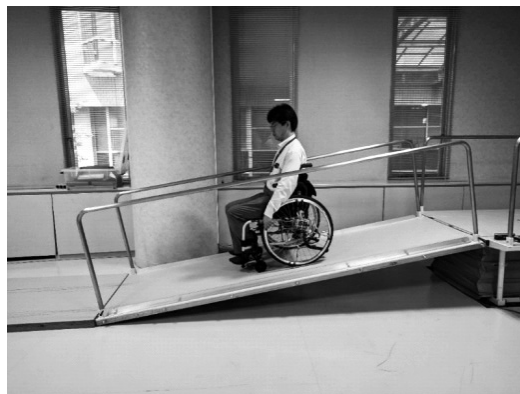
坂路下降のブレーキ力計測実験
