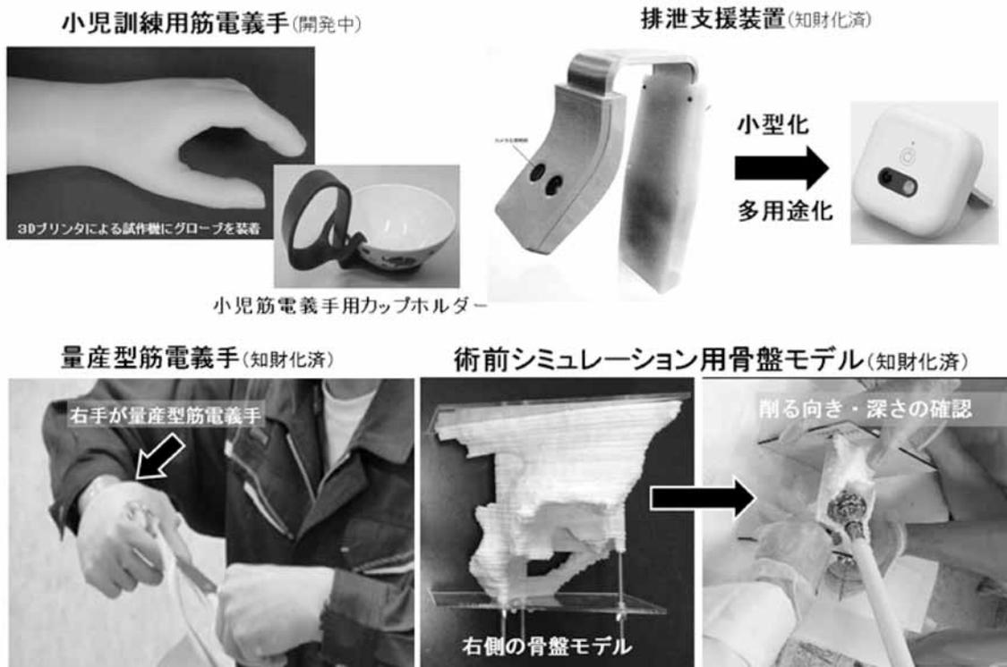
【小児訓練用筋電義手・量産型筋電義手】手を欠損した方の両手を使う日常の動作を補助します。
