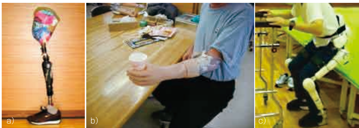
(身体装着型ロボットの例。a)インテリジェント義足, b) 筋電義手, c)ロボットスーツ)
