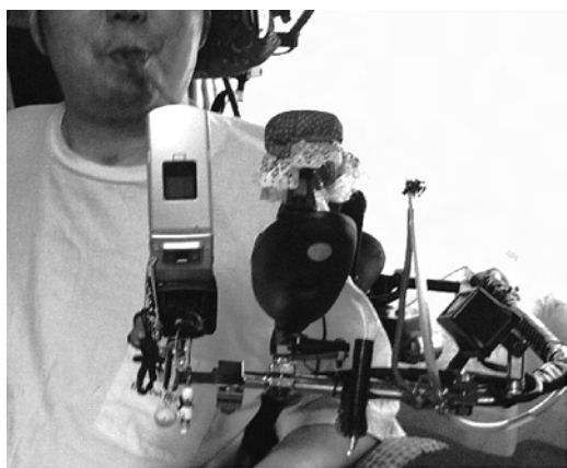
図1 電動車いす上での携帯電話操作 （マウススティックを使用）
