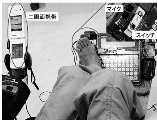
図2 外部スイッチを用いた携帯電話の操作（通話には会話補助装置を使用）
