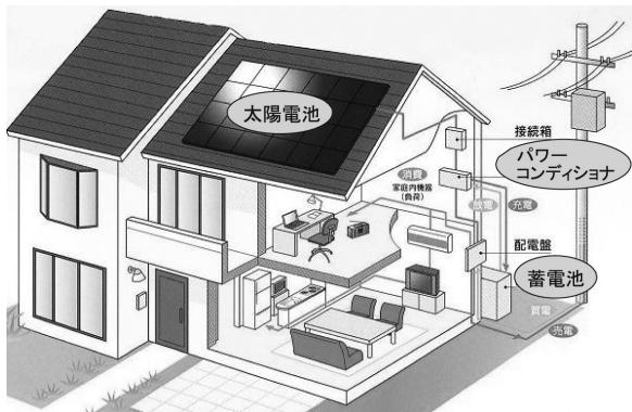
図7 パワーソーラーシステムの構成
