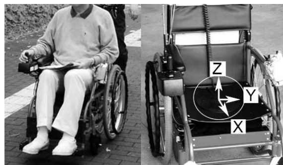
図4 実験状況(左)と身体振動計(右)
