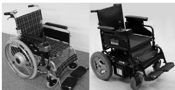
図2 簡易型電動車いす(左)と標準型電動車いす(右)
