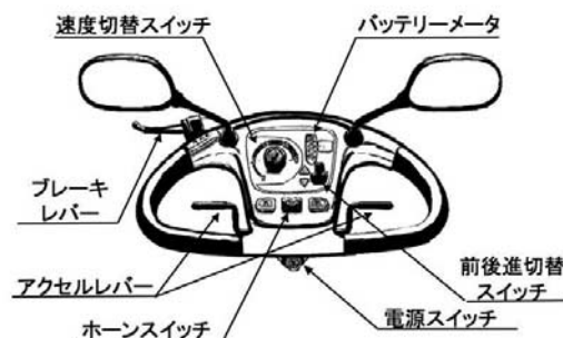
図4 ハンドル型電動車いすの操作部の各部の名称(一例)
