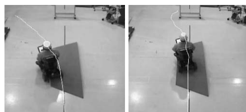
図2 片流れ路面走行 (左:制御なし、右:制御あり)
