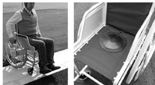
図3 縁石通過実験(左)と振動計(右)
