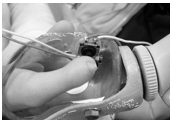
図2 製作したスイッチの操作
