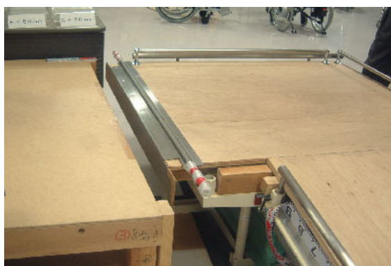
図4 通過実験用段差・隙間外観
