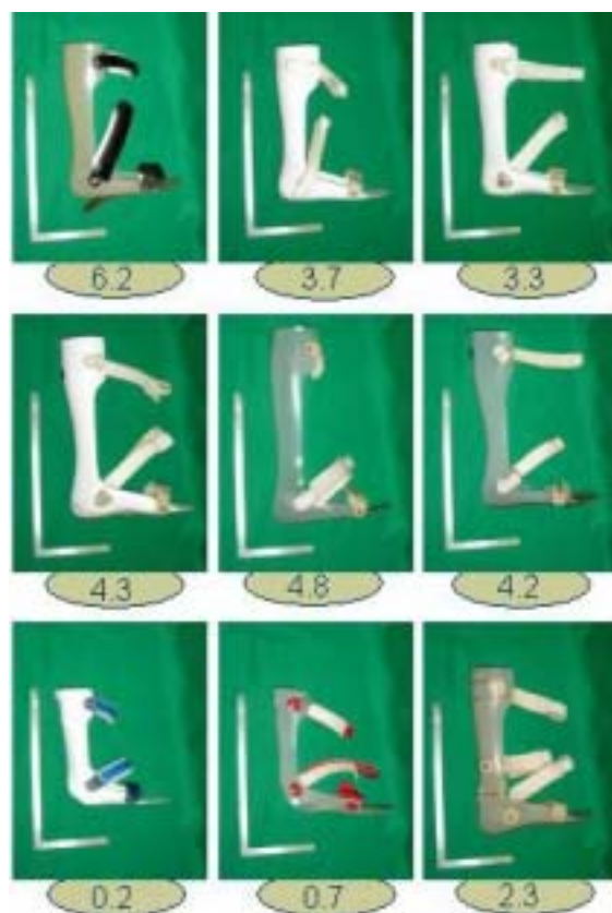
図4 短下肢装具の底屈剛性計測例 単位: Nm/deg
