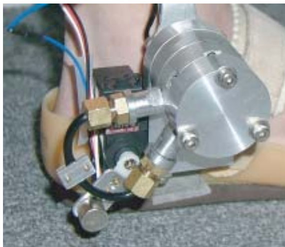
図8 磁気粘性流体を用いた装具用足継手
