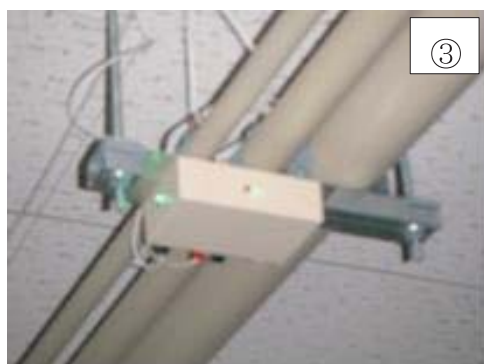
図7 ドアの開閉状態をLED点灯で表示
