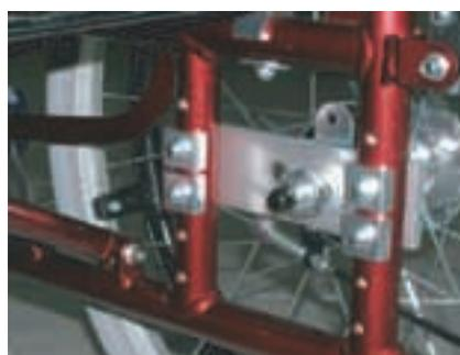
図5 駆動輪取付け位置調整機構
