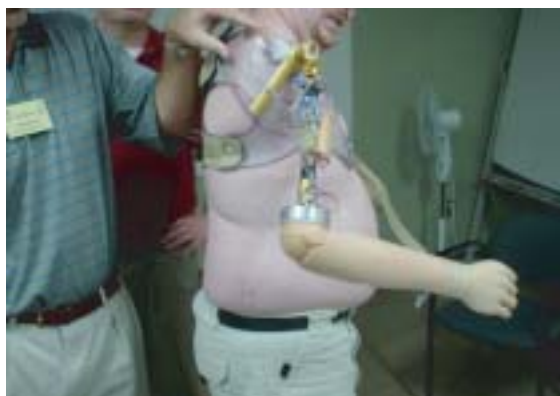
写真3 - 2 : シカゴで開発された高位切断者用筋電義手。肘継手とハンドは筋電制御である。
