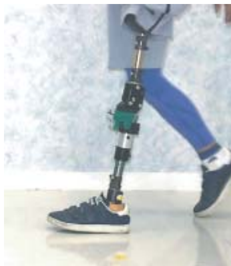
図4 荷重ブレーキ内蔵4節リンク膝継手
