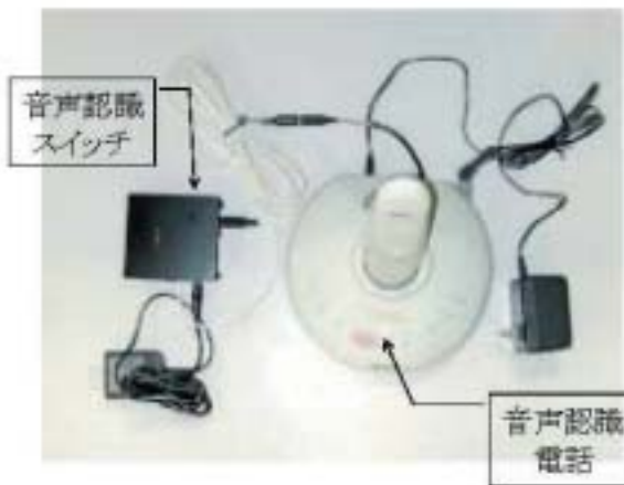
図5 同スイッチによる電話システム
