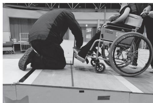
図7 停止位置の誤差の計測方法
