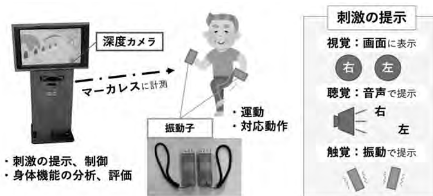
図2 反応速度評価ゲーム“おとさんぼ”の構成
