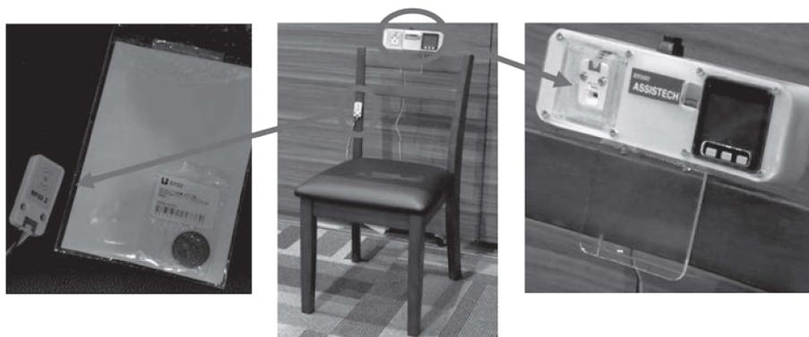
図4 試作した離床センサシステム
