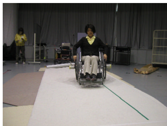
図1 横断勾配実験走行路
