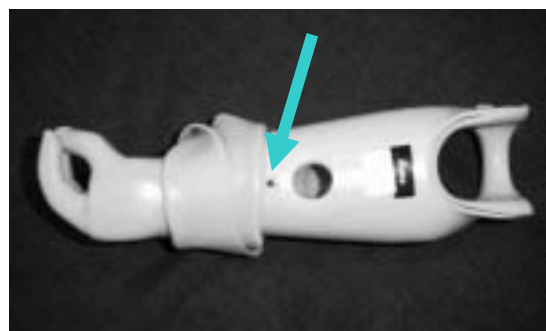
図4 小児用筋電義手(VASI システム) 矢印: parental switch Fig.4 Myoelectric Hand for Infants (VASI system) The arrow shows parental switch.
