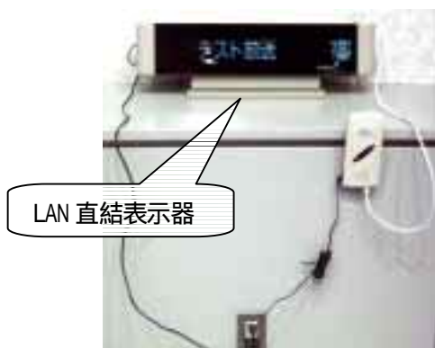
図6 無線アクセスポイントとLAN直結表示器 Fig.6 A wireless access point and LAN type Display
