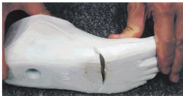
図1 タイ チェンマイ製足部の破損
