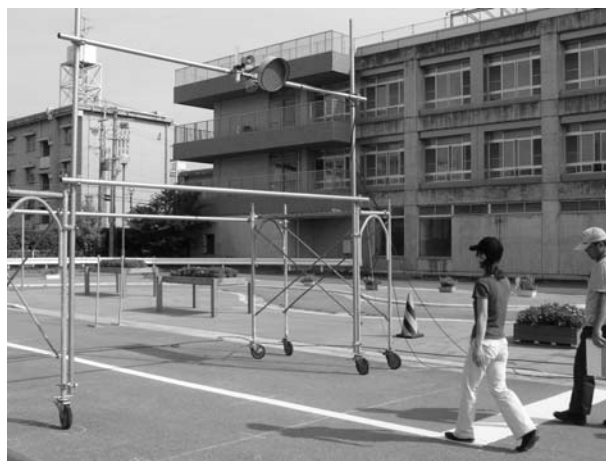
図2 スピーカを設置したゲート Fig. 2 Gate with speakers
