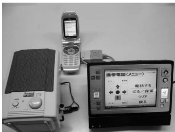
図1 ECS基本モジュールと携帯電話 Fig.1 ECS core module and mobile phone
